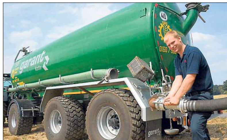
Johannes Hauser kuppelt den Feuerweherschlauch mit Hilfe eines Adapters direkt an das Güllefass an. Bilder: Eickhoff
