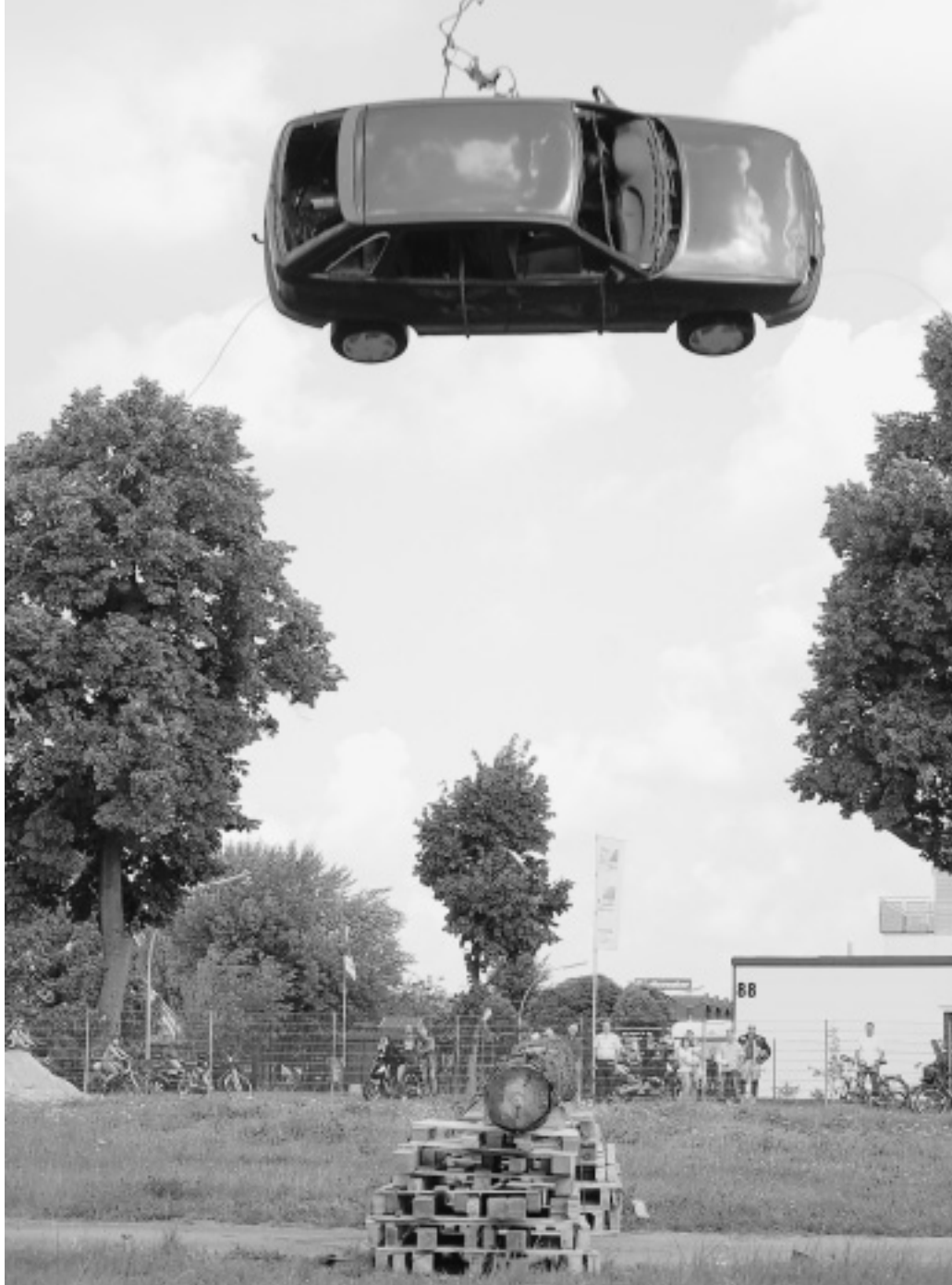
Ein Auto fällt vom Himmel: Der Opel Astra wird von einem Kran aus 15 Meter Höhe auf einen Baumstamm abgeworfen. Damit wird ein Aufprall bei Tempo 50 simuliert.
